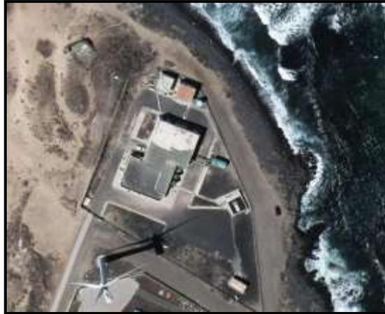
El agua de mar de alimentación a los módulos procede de un pozo playero de muy buena calidad (SDI menor 0,5) que lleva 26 años en servicio. El bombeo se realiza con bombas de captación existentes y la presión en la entrada de los módulos portátiles estará entre 3 – 4 Bar y se conectarán a los filtros de arena existentes.
